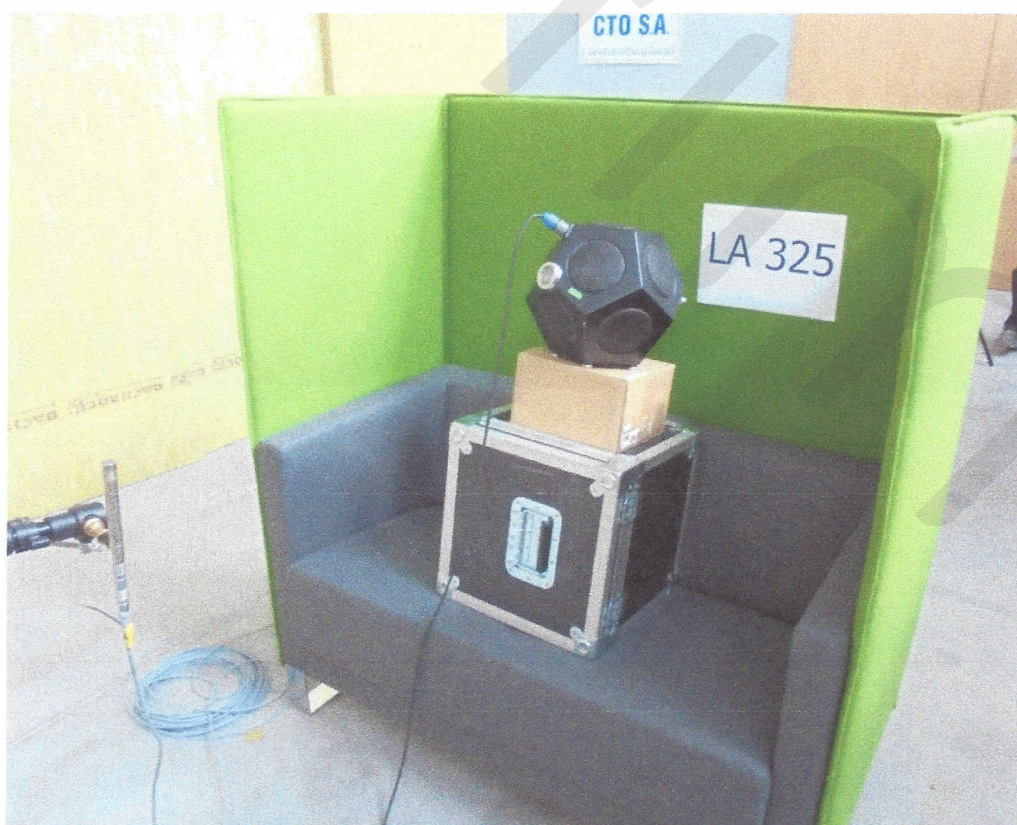
Rys. 5. Umieszczenie źródła dźwięku na sofy na wysokości 110 cm.
