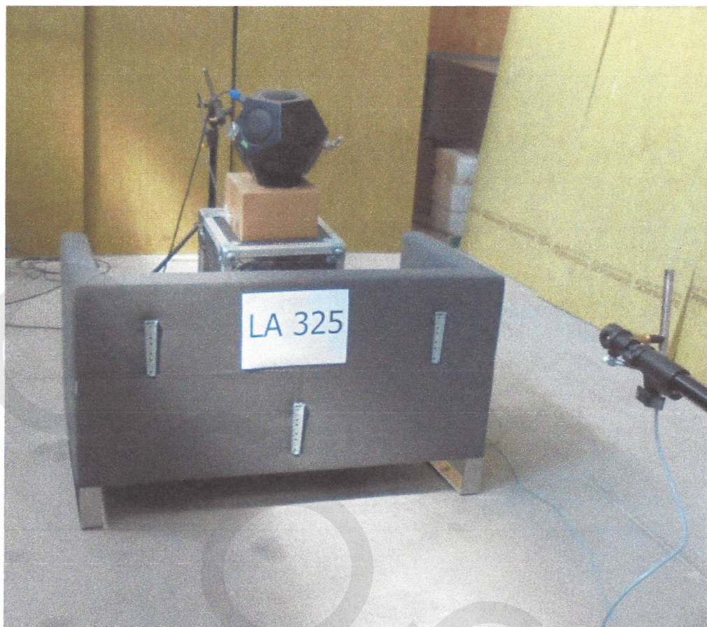
Rys. 4. Umieszczenie mikrofonu w odległości 140 cm od sofy bez parawanu.
